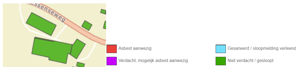
Figuur 4: Verdachtheid op asbesthoudende dakbedekking.
