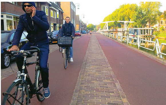
Fietsstraat uitgevoerd in asfalt
