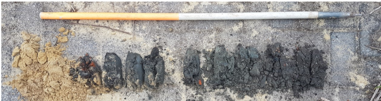
Figuur 23: Foto van boring 2, uitgelegd per meter van links boven naar rechts onder.
