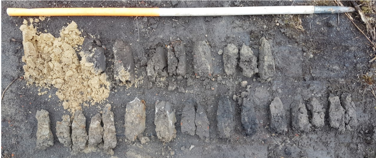
Figuur 22: Foto van boring 1, uitgelegd per meter van links boven naar rechts onder.
