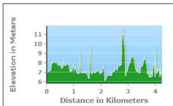
Afb. 5 – Lengteprofiel. Het lengteprofiel van het projectgebied.
