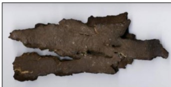
Afb. 14 - scherf door detonatie
