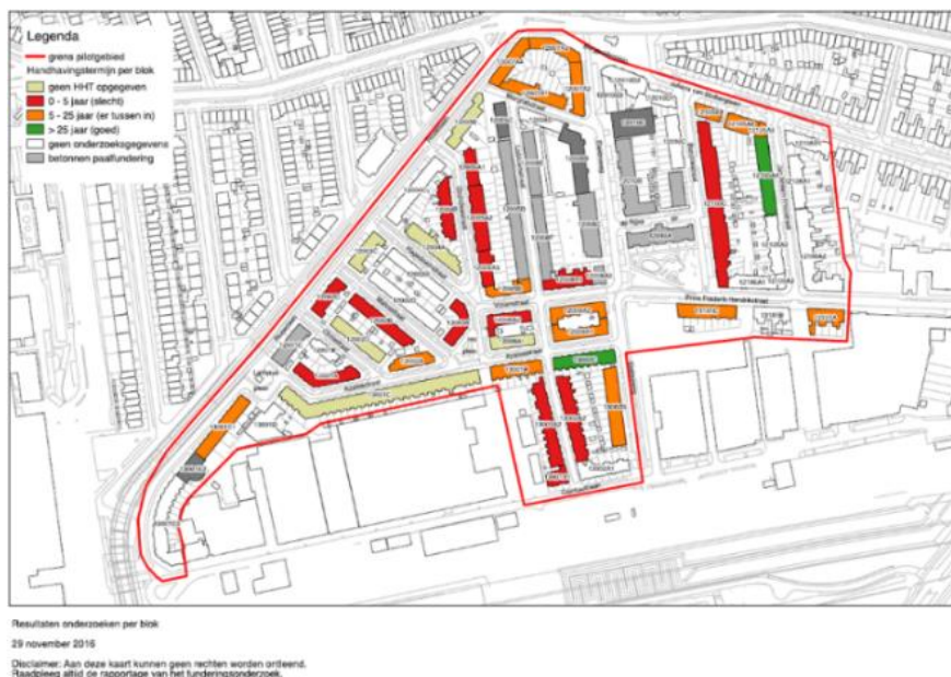
Figuur 33 Boven: Droogstand in de Bloemenbuurt en Gravenbuurt. Onder: Resultaten funderingsonderzoek in de Bloemenbuurt en Gravenbuurt.
