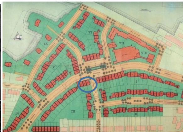
Figuur 27 Links: Het deels nog onbebouwde Statenlaankwartier. De licht strepen en stukken laten zien waar de sloten en veenput heeft gelegen. Die zijn deels opgevuld met zand en kleuren om deze reden lichter dan de klei- of veengrond. Rechts: Stedenbouwkundige ontwerp Statenlaankwartier. Het gemarkeerde deel geeft de panden aan waar problemen zijn (geweest)
