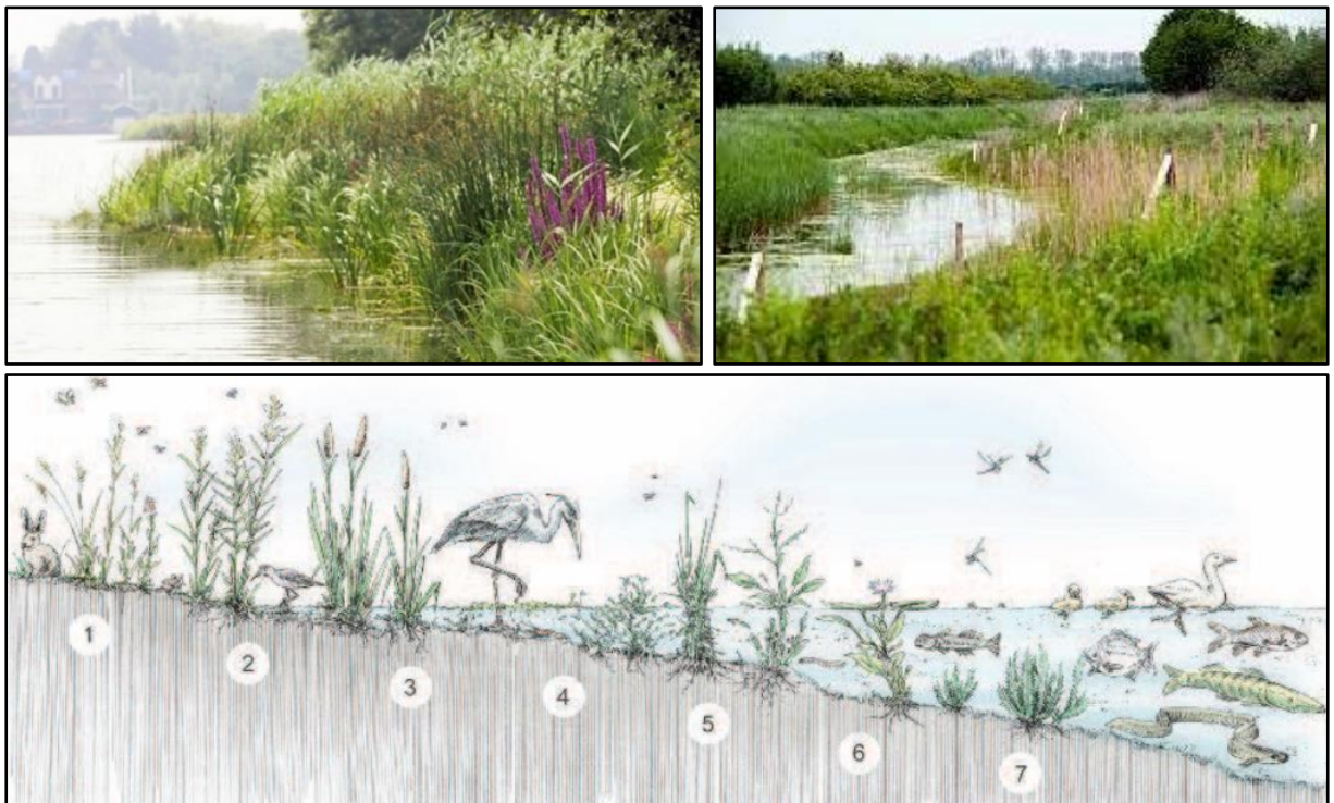
Figuur 4.1. Boven: voorbeelden van natuurvriendelijke oevers. Onder: Een schematische illustratie van een natuurvriendelijke oever met verschillende zones - 1: bloemrijk grasland, 2: vegetatie van vochthoudende grond, 3: vegetatie van natte ruigtes (plas-dras), 4: moerasplanten in ondiep water, 5: moerasplanten in dieper water, 6: drijfbladplanten, 7: ondergedoken waterplanten. Bron: Handreiking natuurvriendelijke oevers, STOWA, 2009.
