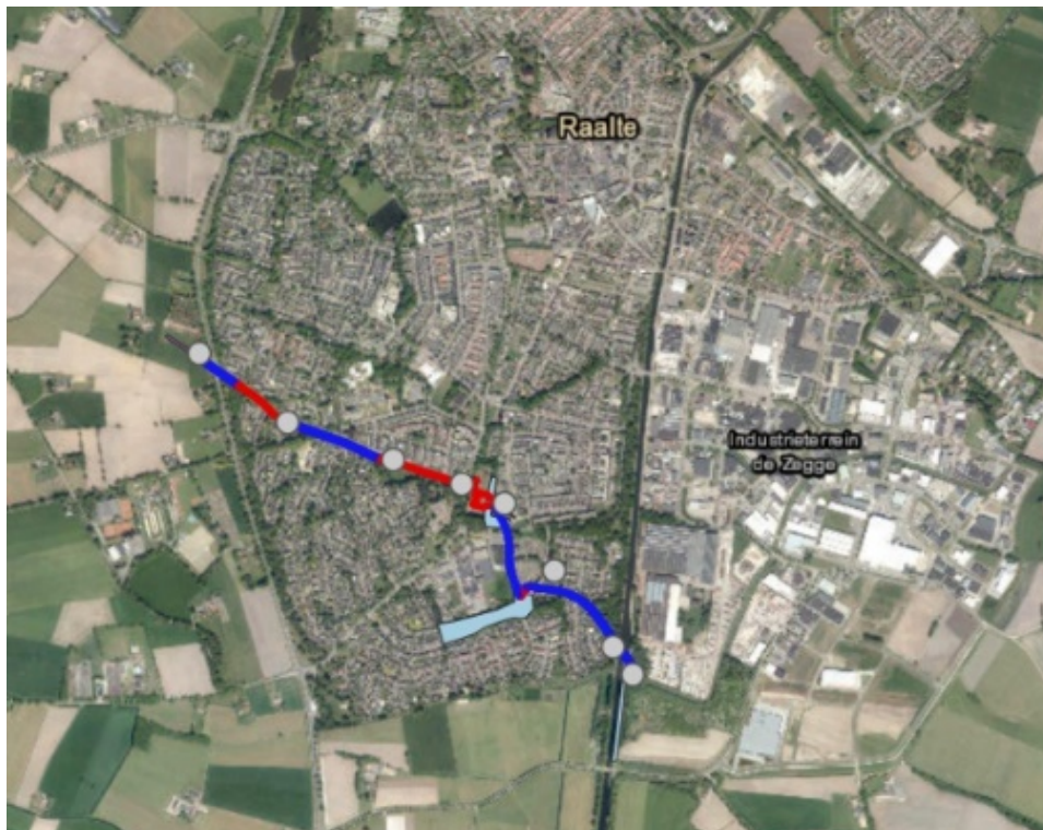
Figuur 1.1: Globale ligging van het tracé (rood= open ontgraving, blauw= HDD-boring, lichtblauw= uitlegstrook en de grijze stippen zijn de hoogspanningsmasten) (bron achtergrond: Esri).
