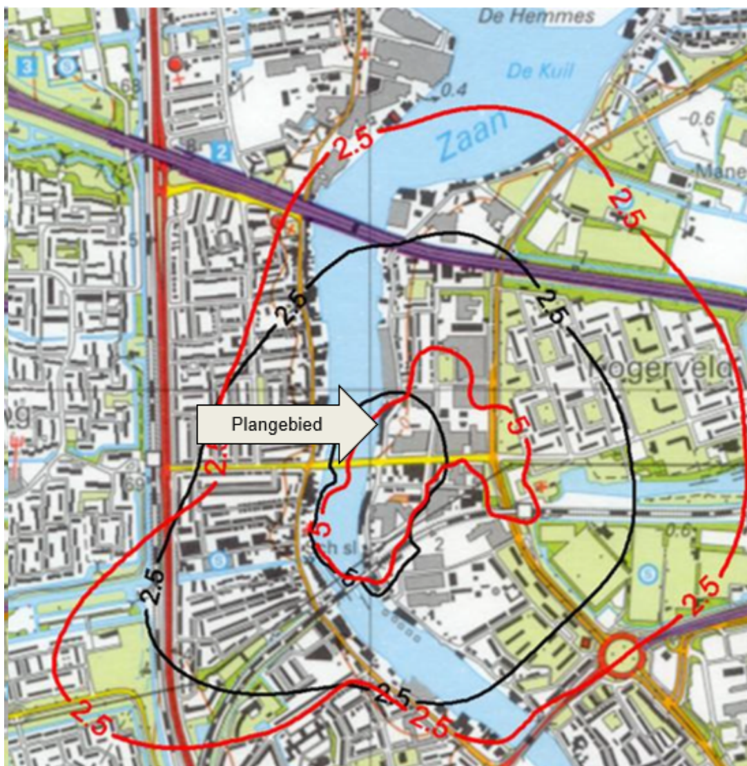
Afbeelding 3.9. Contouren Cargill “de Jonker” (streefwaarde is 5 OUE/m 3 bij 98 percentiel). In zwart de vergunde contouren, in rood de contouren waarbij de zuivering is uitgevallen.
