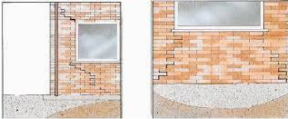
Mechanisme zetting / zakking fundering op staal
