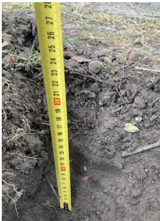
Beeld van de profielkuil met verdichte kiezel/splitlaag
