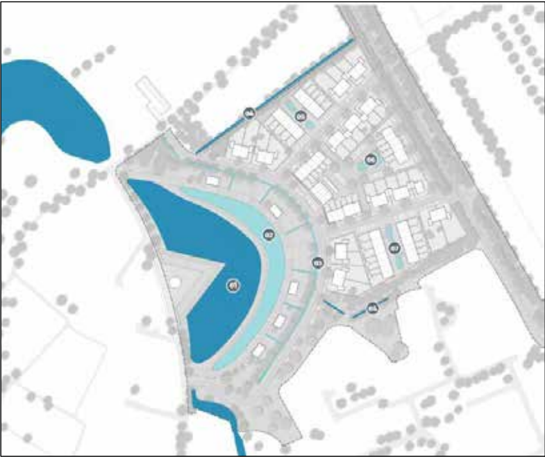
Afbeelding 3: watersysteem nieuwe wijk (voorlopig ontwerp).
