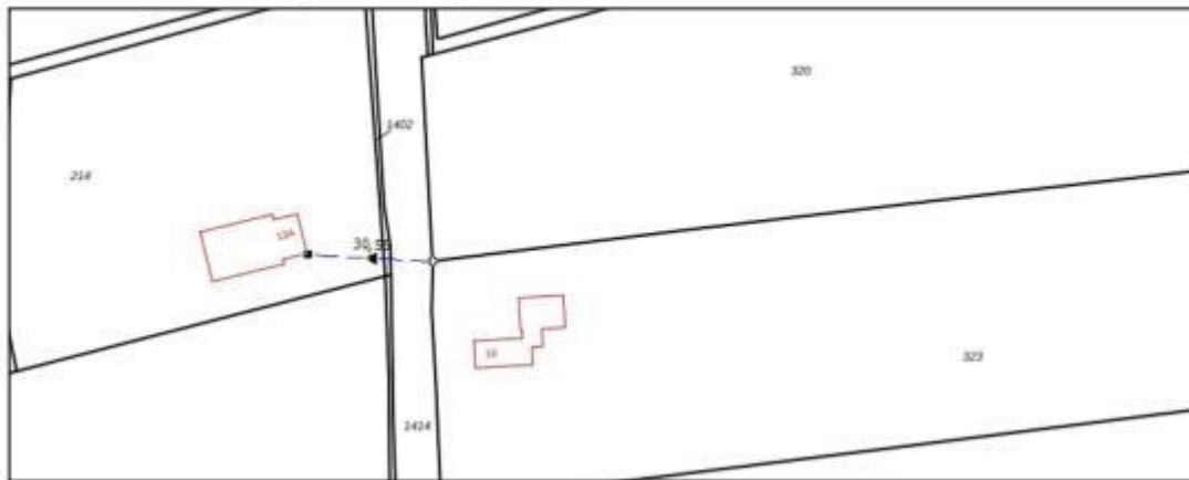
Afbeelding 1: Afstand (30,55 m) tussen de perceelsgrens Skûlenboargerwei 10 en de gevels van de woning Skûlenboargerwei 13A
