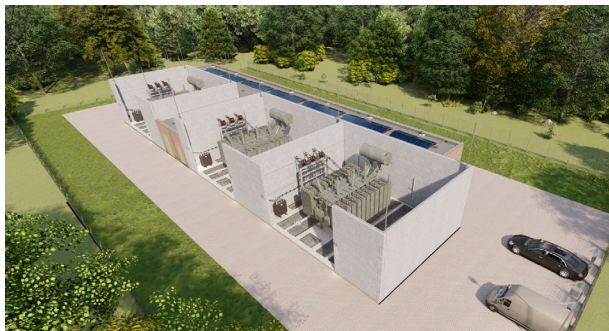
Impressie Station Liander met installatieruimte en transformatorruimten Dit is geen exacte impressie van het nieuwe 150kV/50kV station.
