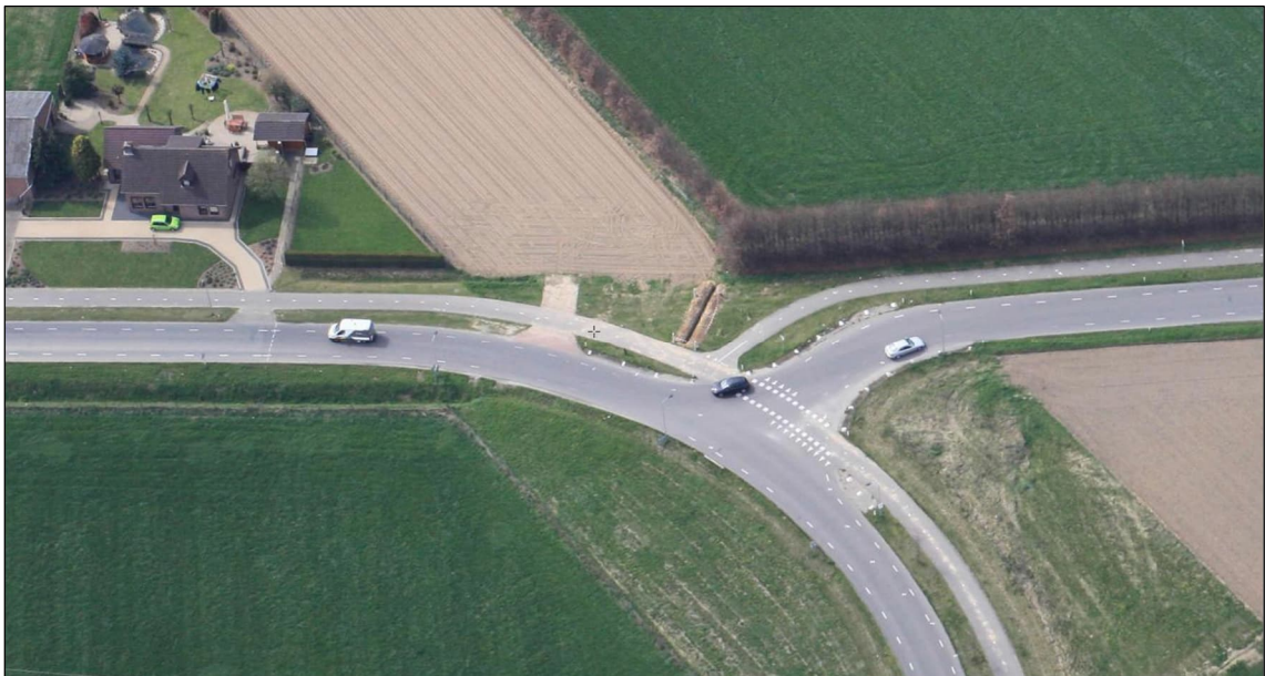
Afbeelding 7 Voorbeeld principe maatregel afbuigende voorrangsweg
