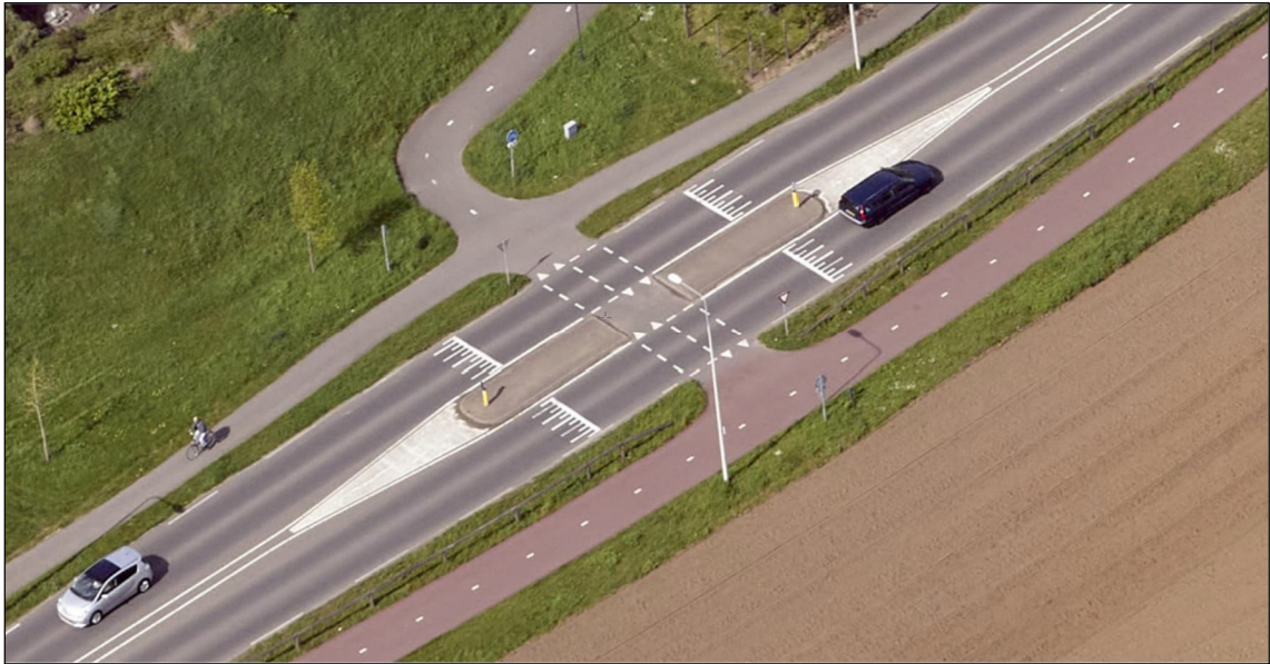
Afbeelding 6 Voorbeeld principe maatregel gefaseerde fietsoversteek met plateaus
