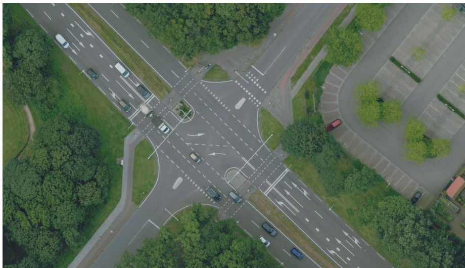
Figuur 5: Kruising Nijmeegseweg - Straelseweg biedt in zijn bestaande vorm geen mogelijkheden om de capaciteit uit te breiden. Een omvangrijke aanpassing is daarvoor noodzakelijk.
