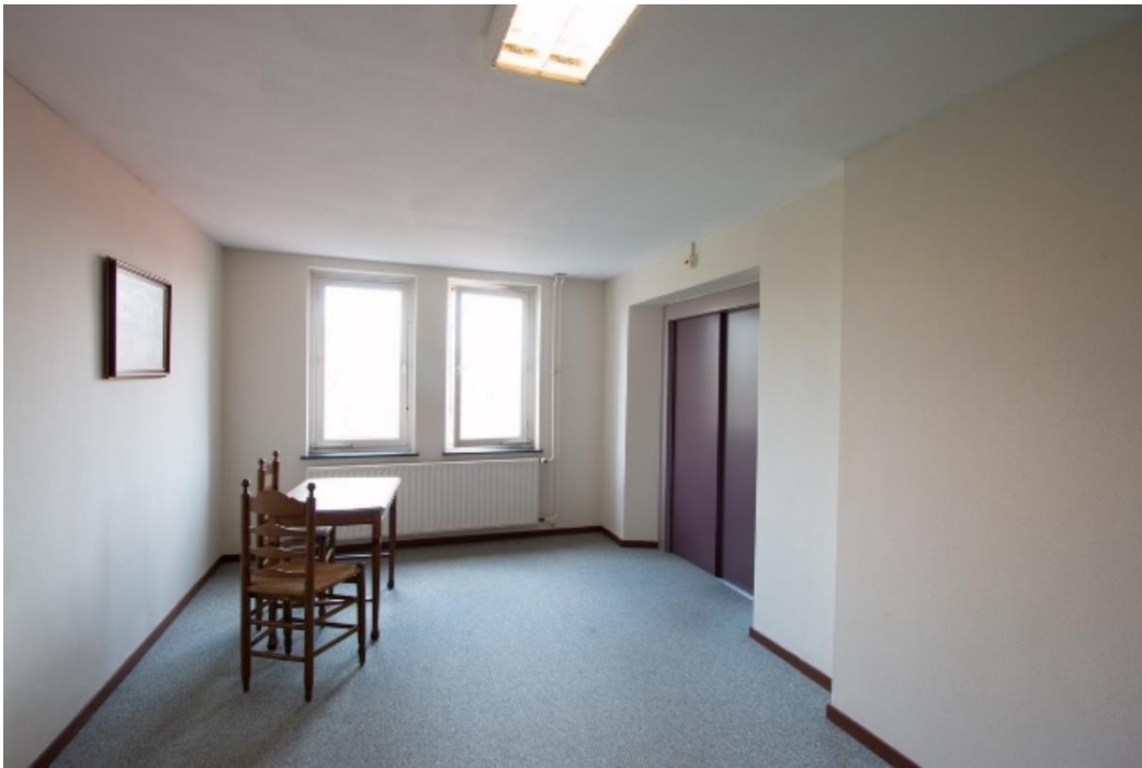
De overloop met de lift in de schacht die in 1974 werd aangebouwd.
