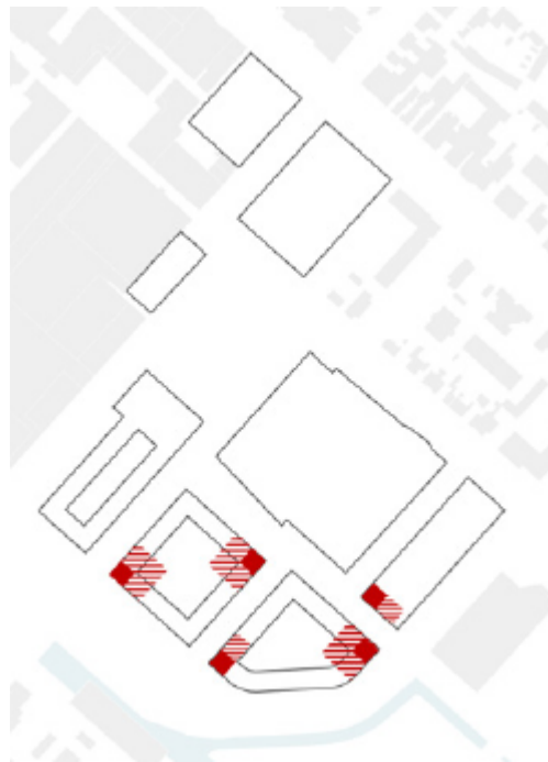
Figuur 4.4: Zoekgebied voor hoogteaccent (dicht gekleurd) en voor verspringing hoogteaccent (gearceerd), weergegeven op een voorbeeld uitwerking van het stedenbouwkundig plan.
