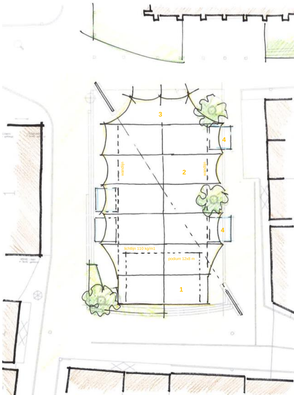
Figuur 11 Plattegrond van de volledige tentconfiguratie met podiumoverkapping (1), publieksoverkapping (2), kopgevelluifel (3) en bartenten (4).
