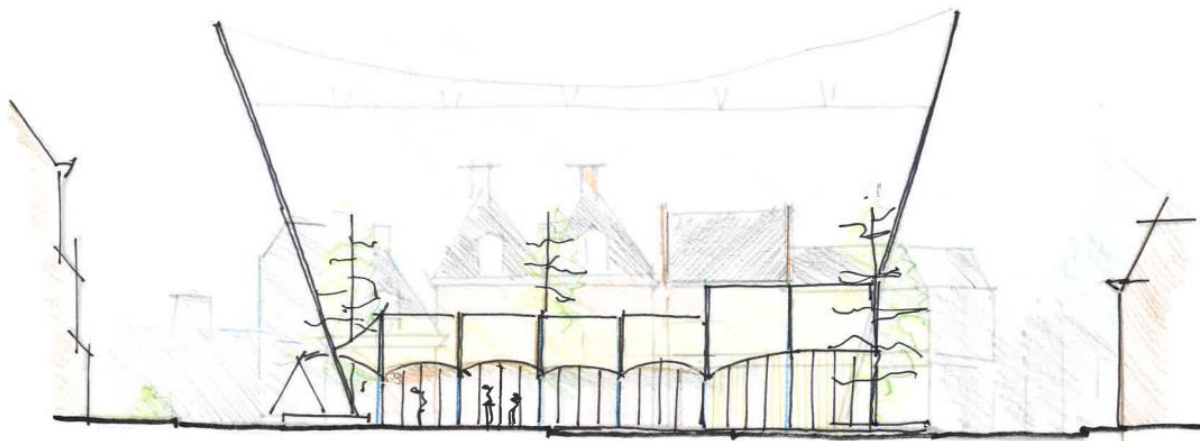
Figuur 12 Zij aanzicht van het schetsidee met hoogteverschil tussen publieks- en podiumdeel.
