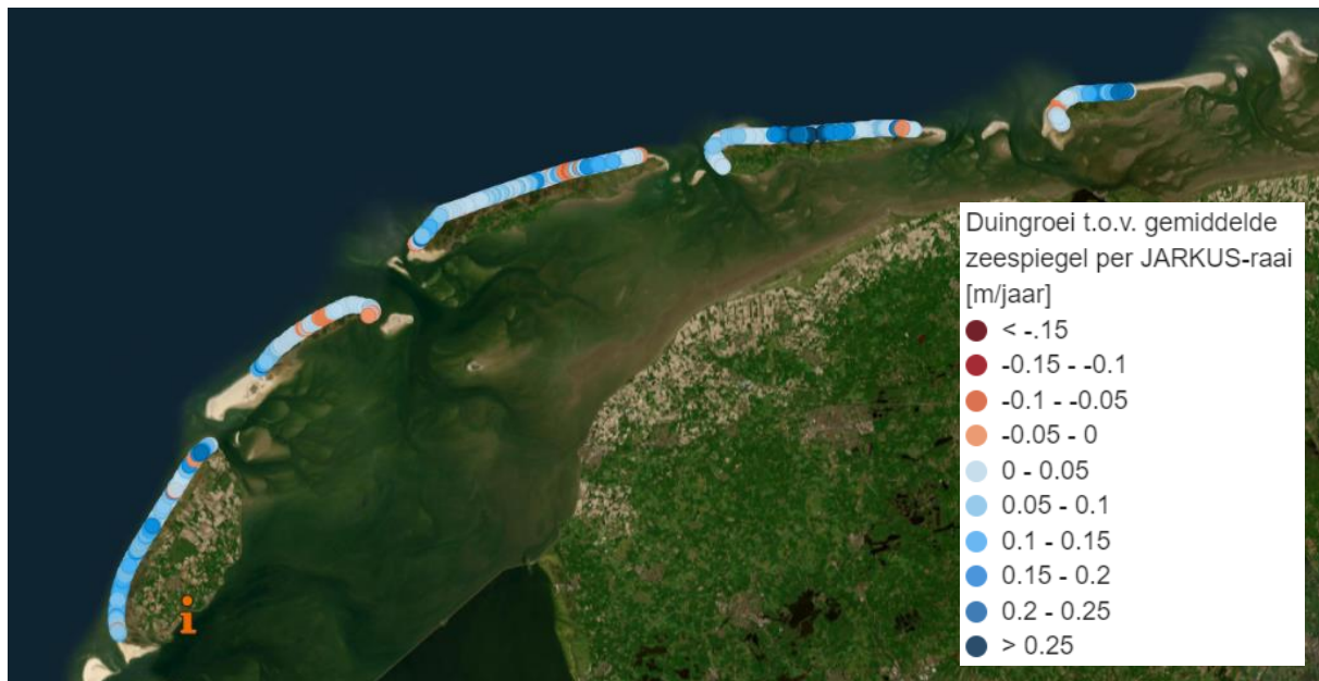
Figuur 10 Aanzanding van de duinen op de Waddeneilanden in de periode 1990-2021. Weergegeven is of het dwarsprofiel zoveel meegroeit dat het een zeespiegelstijging van 50 cm tot 2100 op kan vangen (zoals eerder is onderzocht in Wegman et al., 2021 7 , https://dmmangrove.hkvservices.nl/blokkendoos-levende-kust/ ).
