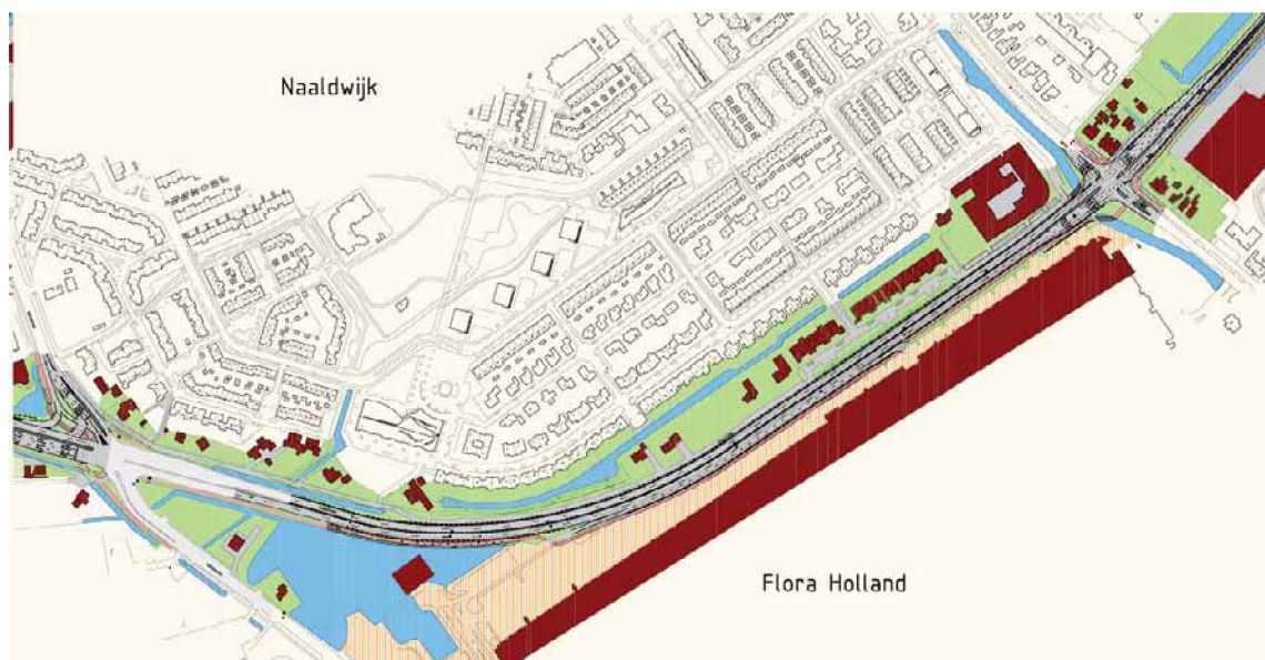
Figuur 2.2 Wegontwerp verdubbeling N213 (bron: provincie Zuid-Holland)
