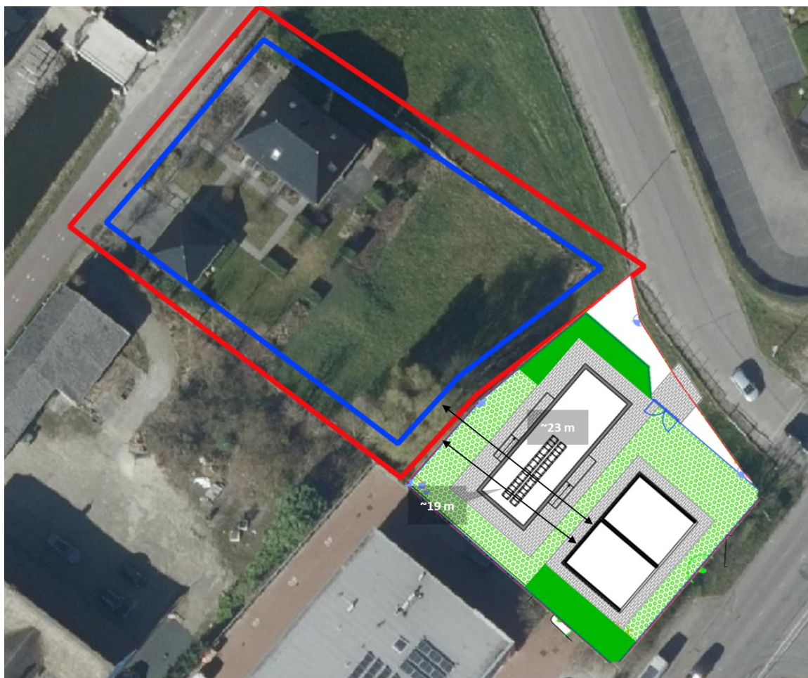
Afbeelding 3.1 Situering van het beoogde transformatorstation en de afstand van de trafocellen tot de grens van de bestemming wonen (rood) en tot de uiterste situering van de gevel van de woning die het bestemmingsplan toelaat (blauw)
