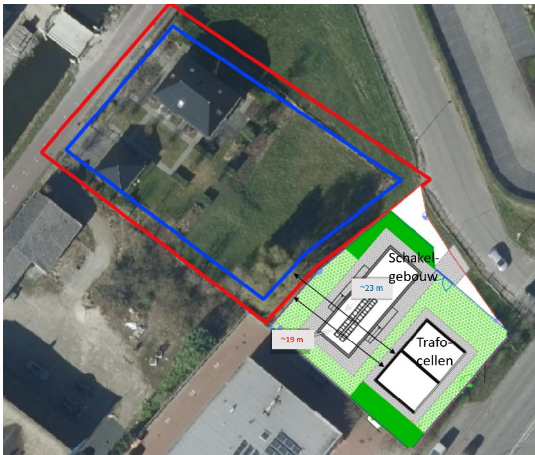
Afbeelding 2.3 Situering van het beoogde transformatorstation en de afstand van de trafocellen tot de grens van de bestemming wonen (rood) en tot de uiterste situering van de gevel van de woning die het bestemmingsplan toelaat (blauw)
