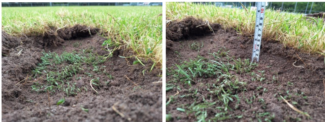
Afbeeldingen 4 en 5 : De kunststofvezels onder een laag grond en graszode
