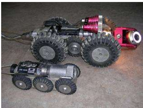
Beheer en onderhoud, inspectie riolen
