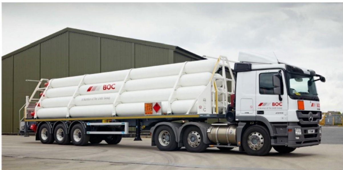
Een tube-trailer met 9 stalen drukcilinders (200 bar) (M-Tech, 2020)
