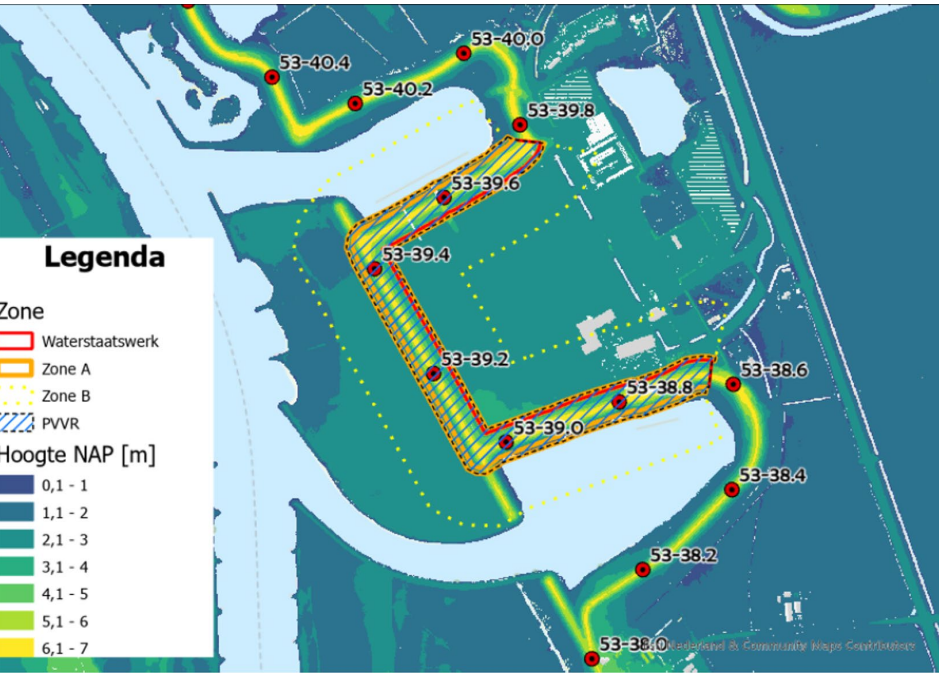
Figuur 6.1.2 | Waterstaatswerk en zonering van de dijk
