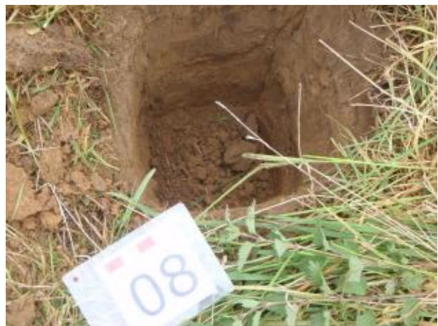
Foto 6: Voorbeeld van een proefgat voor onderzoek naar asbest in de bodem. Bodem bestaat uit löss (leem).
