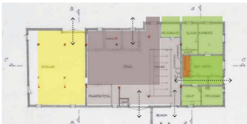
Ordering / hoofdopzet van de boerderij in resp. de perioden pré 1830, 1830 en 1880 getekend over de huidige plattegrond. In groen de woonruimtes, rood de haard en gebintstijlen, bruin de stal/potstal en de 'deel' en tasruimtes in geel.
