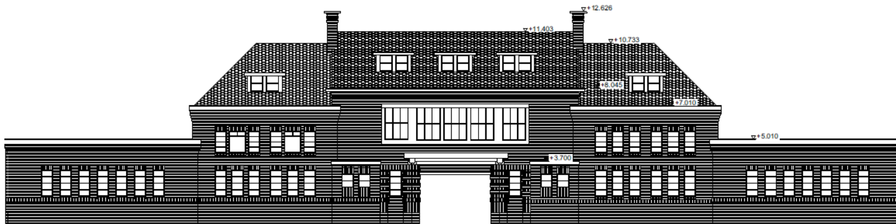
Afb. 4.2: Vooraanzicht van het oude poortgebouw van het voormalige fabriekscomplex dat gerenoveerd moet worden
