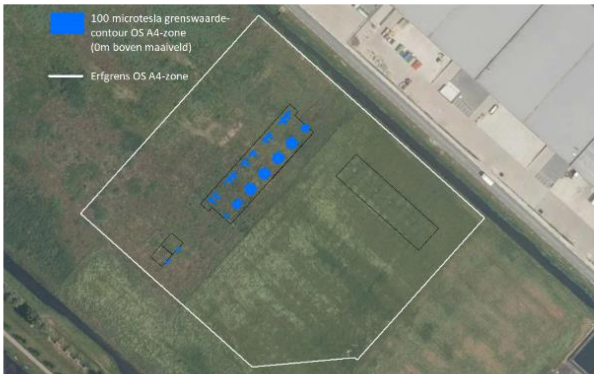
Figuur 3: 100 microtesla magneetveldcontour eindsituatie OS A4-zone (0 meter boven maaiveld)
