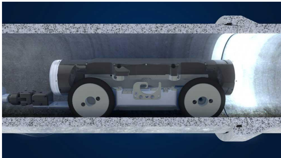
Figuur: inspectie riolering m.b.v. camera
