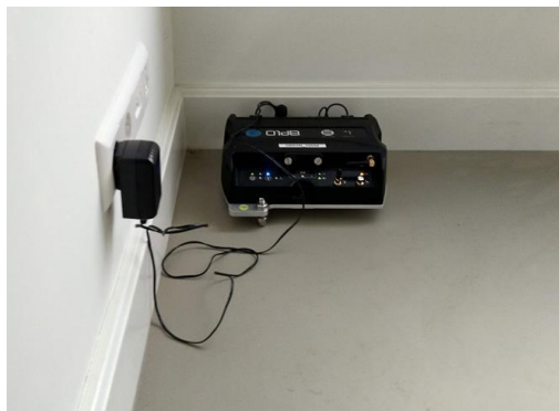
figuur 16 Trillingsapparatuur met een tri-axiale versnellingsopnemer.
