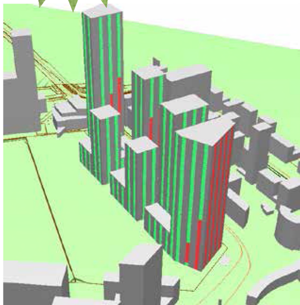
Geluidsimulatie gevelbelasting zuidwestgevels
