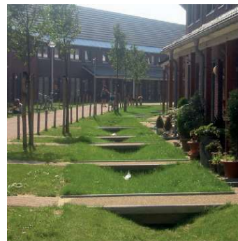
eenvoudige plaatbrug over berm/ greppel
