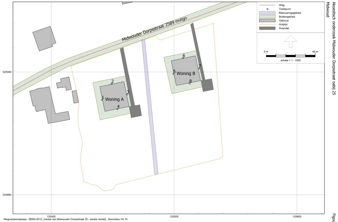
Plot van Overdrachtsmodel met de reken/beoordelingspunten op gevels nieuwe woningen A en B
