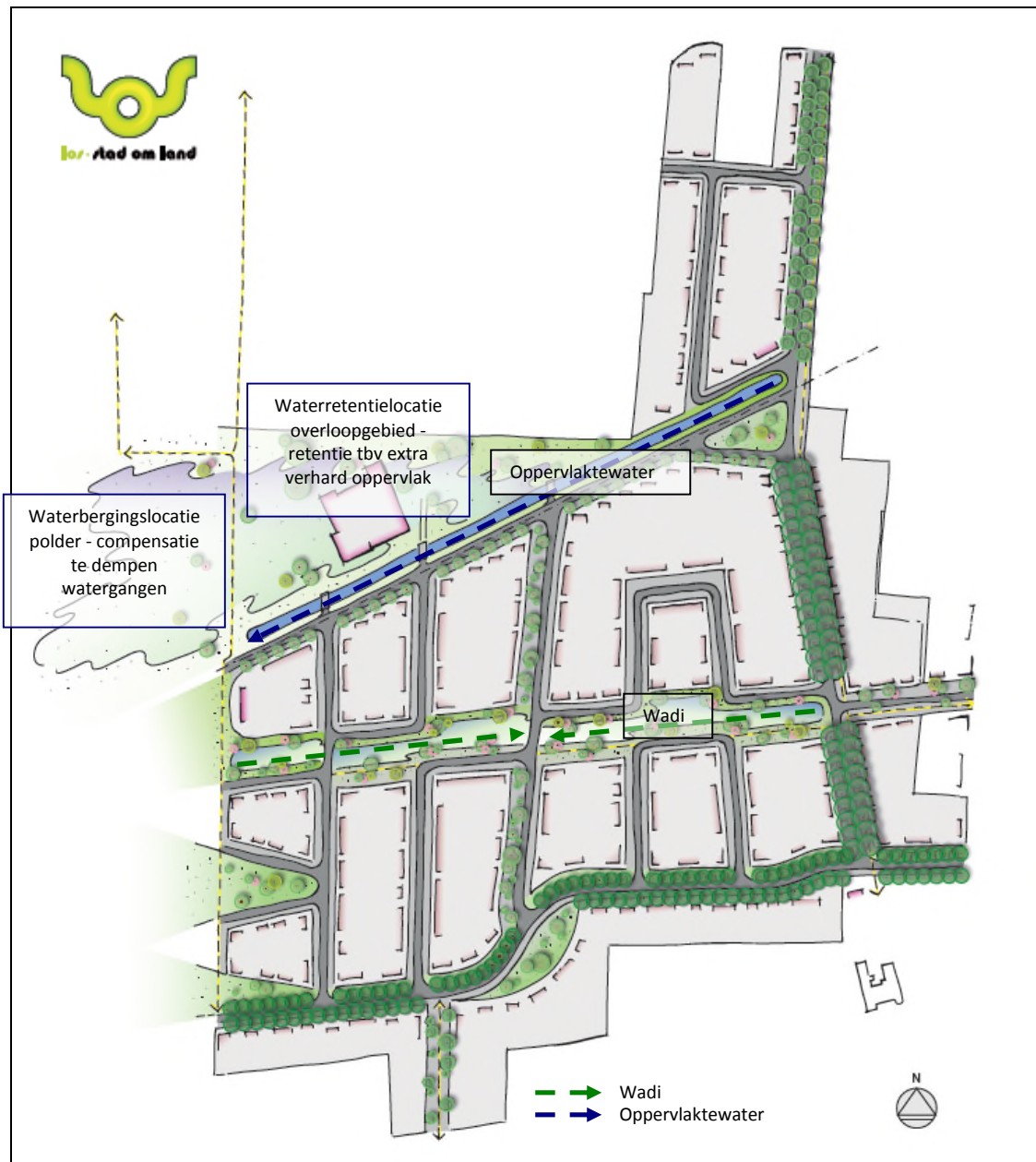
Figuur 4.2 schetsmatige weergave principe watersysteem Sweetsstraat-West
