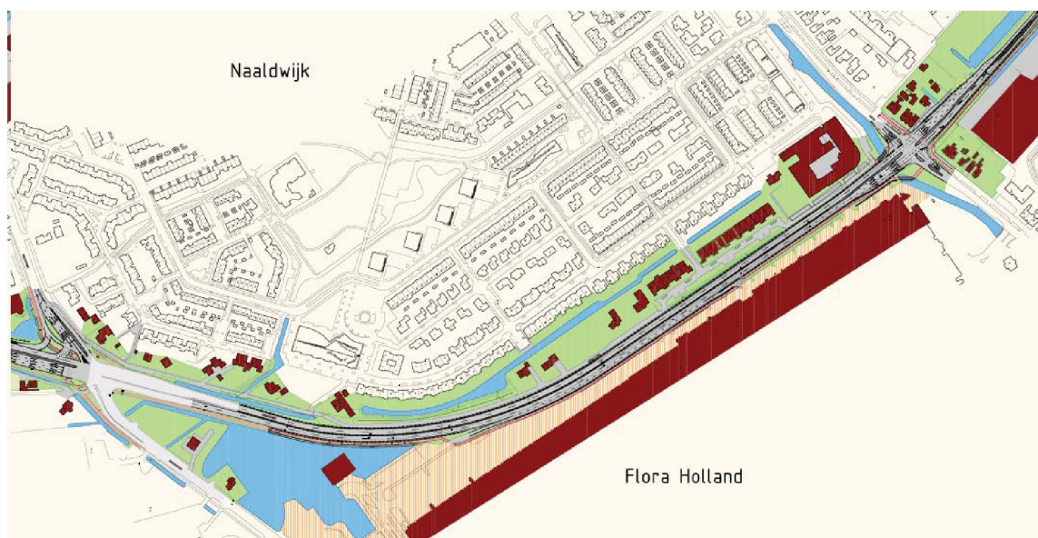
Figuur 2.2 Wegontwerp verdubbeling N213 (bron: provincie Zuid-Holland)
