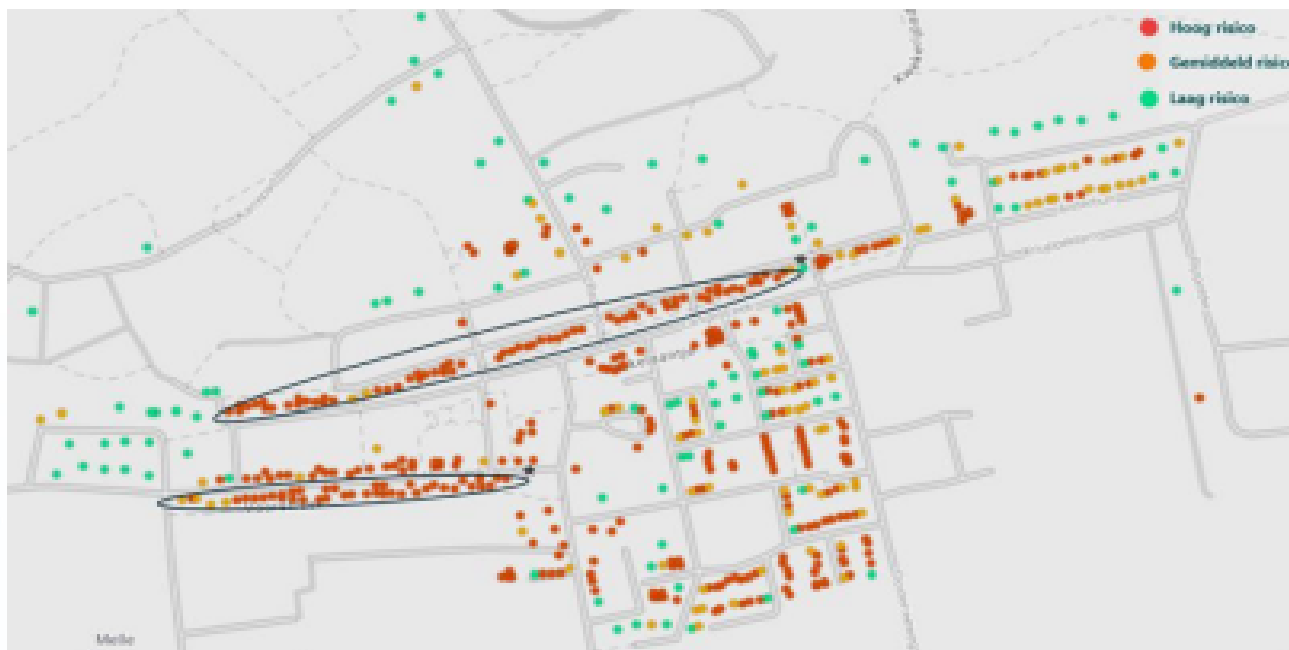
Figuur 6.3: Overzicht van risicoschatting van geluidsoverlast voor warmtepompen die 65 dB aan geluid produceren.
