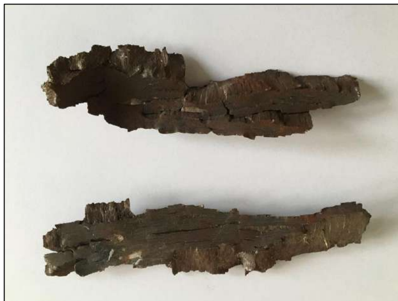
Afbeelding 45: Scherven na detonatie van een met springstof gevuld OO.
