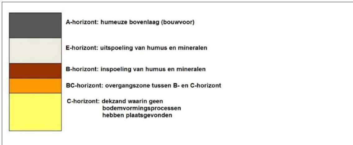
Figuur 8. Nijberkoop, Bovenweg 23: Schematische weergave van een intacte podzolbodem.
