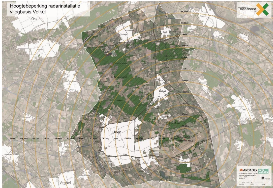
Figuur 14 Maximale toegestane hoogte bouwwerken radarstation Volkel (Grotere weergave bijlage 5)
