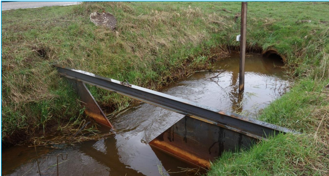
Figuur 5 Voorbeeld van een debietmeting met een V-stuw en waterhoogte meter
