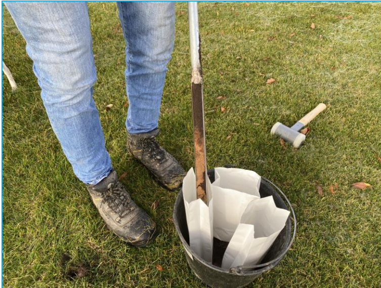
Figuur 3 steken van bodemonsters op drie dieptes – op een perceel worden meerdere steken genomen waarbij voor elke bodemlaag (0-30, 30-60 en 60-90 onder maaiveld) in een apart mengmonster wordt verzameld
