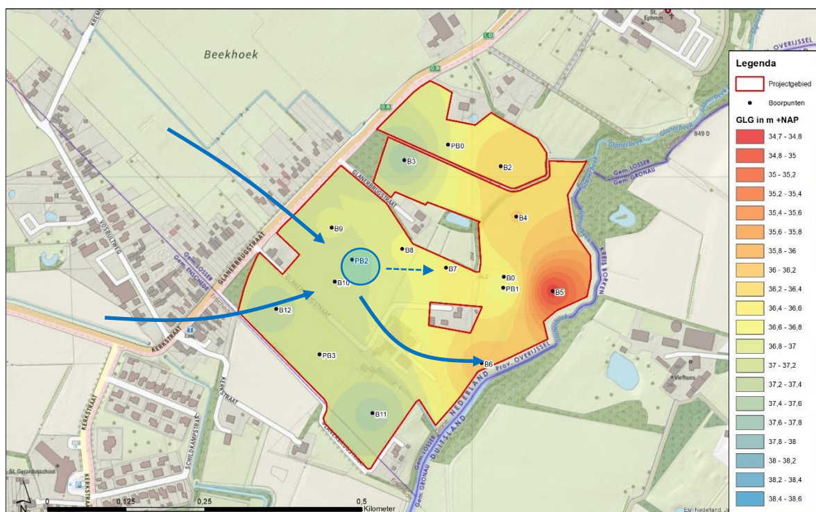
Figuur 23: Schets realisatie poel met stroompijlen van het grondwater en verloop GLG +NAP.
