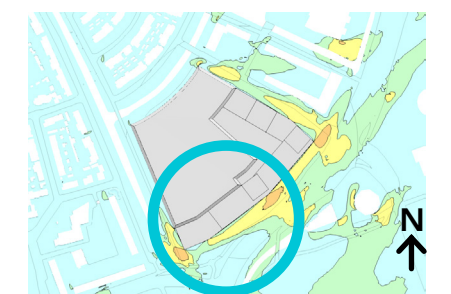
Figuur 5.2: Stroomlijnen richting de overschrijdingen op de zuidpunt van het gebouw en aan de President Kennedylaan
