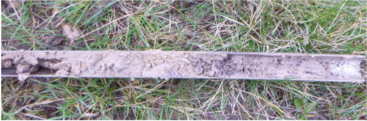
Figuur 19: Foto van de overgang van sterk zandige klei (links van het midden), via grof zand (rechts van het midden) naar grind (geheel rechts) zoals deze onderin de boringen is aangetroffen.
