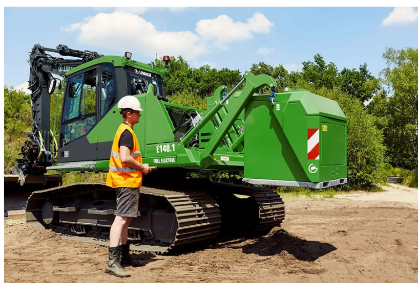
Figuur 1. Graafmachine met uitneembare batterij
