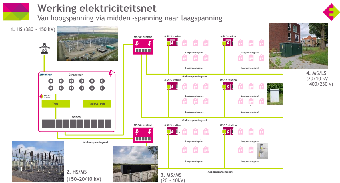
Figuur 6: Werking elektriciteitsnet
