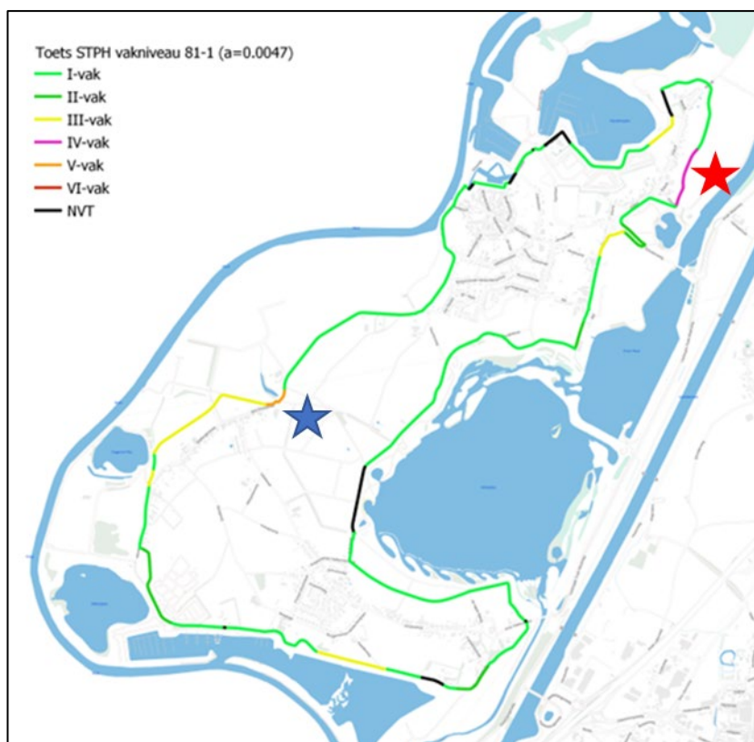
Figuur 9.6 Beoordelingsresultaten voor het faalmechanisme piping waarbij rekening is gehouden met bewezen sterkte op basis van het hoogwater van juli 2021. De blauwe ster toont de locatie waar sprake was van een zandmeevoerende wel. De rode ster toont een dijkvak dat slecht is beoordeeld, maar waar geen sprake was van een incident.
