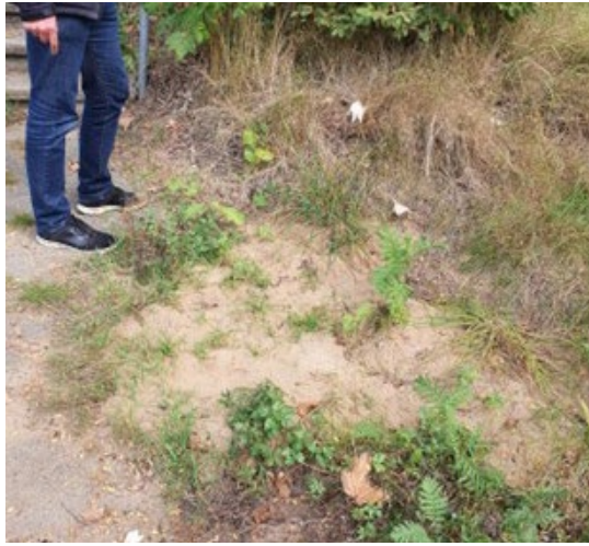
Figuur 9.11 Zandmeevoerende wellen bij locatie (2) tijdens het veldbezoek na afloop van het hoogwater
