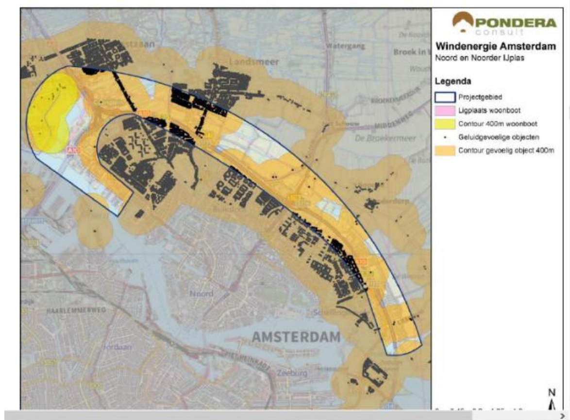
Figuur 2.2 Gevoelige objecten en 400 meter contouren (windturbine categorie 2 & 3)
