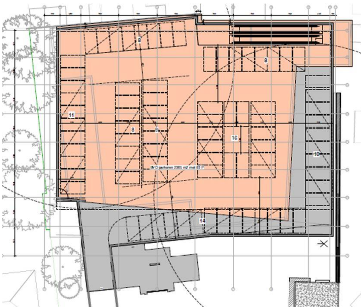
Overzicht parkeerplaatsen (bron: D&M Architecten Adviseurs)
