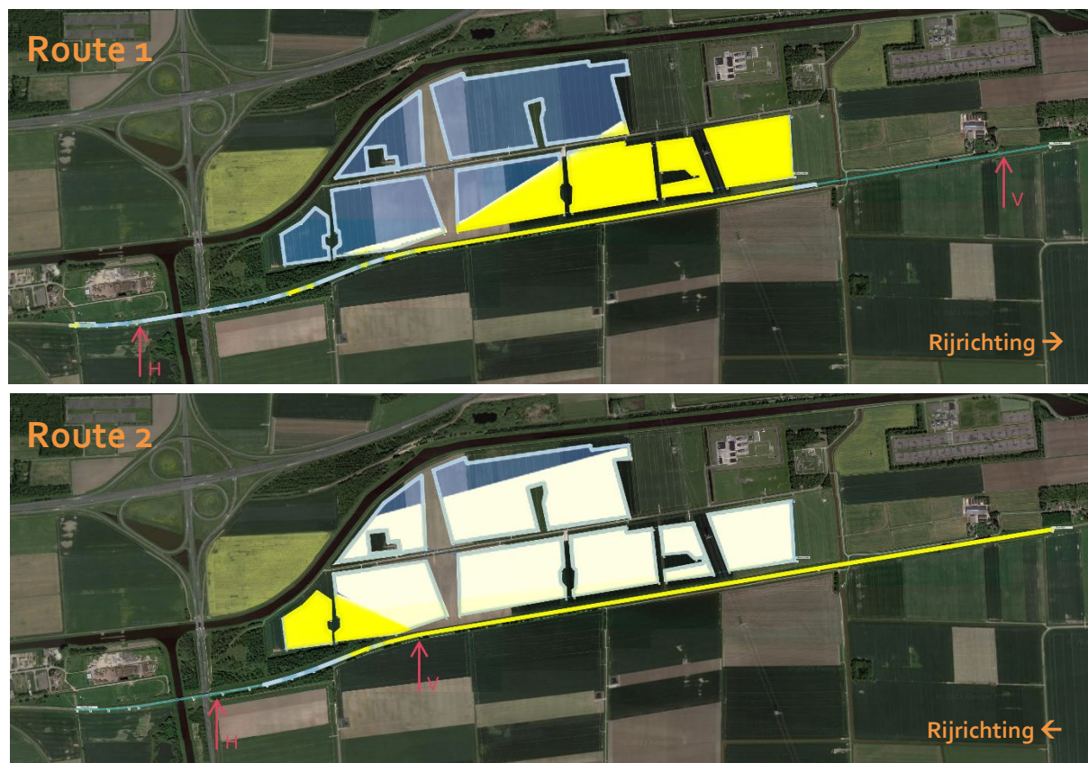
Figuur 4.2: Schitterende delen van de zonnepanelen, zichtbaar vanaf de routes en de plekken op de route waar de reflectie tot hinder leidt. Hoe gelser de kleur, hoe meer reflectie. Relevante seinposities zijn met een rode pijl aangegeven, een H voor hellingseinen, een V voor voorseinen. Boven: Route 1, onder: Route 2.
